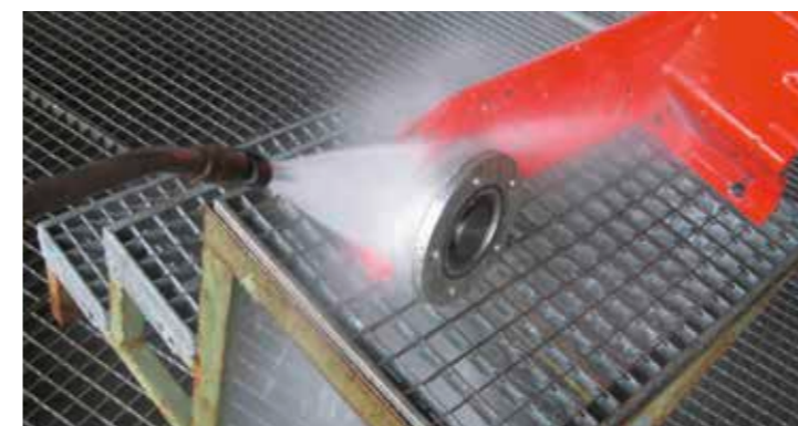
Bild 3: Wasserstrahltest über 200 Stunden. Nach Beendigung des Tests konnte kein Eindringen von Wasser durch die Kassettendichtung festgestellt werden.
