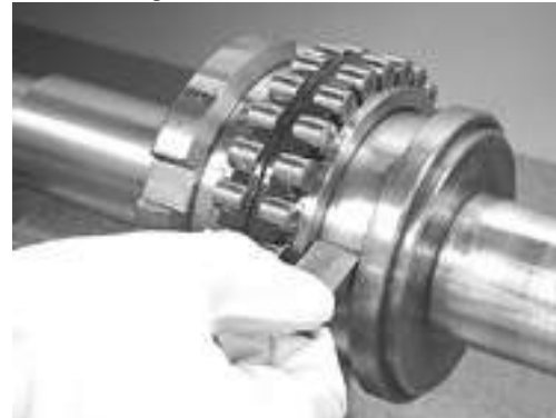
Abb. 1.15: Messen der erforderlichen Zwischenringbreite
