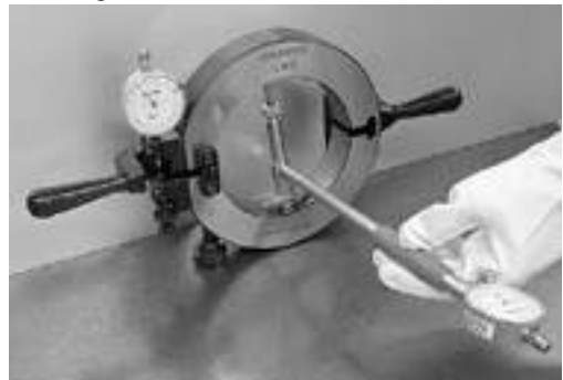
Abb. 1.11: Laufbahndurchmesser des Außenrings auf das GN-Hüllkreismessgerät übertragen
