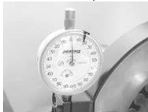
Abb. 1.15: Messen der erforderlichen Zwischenringbreite
