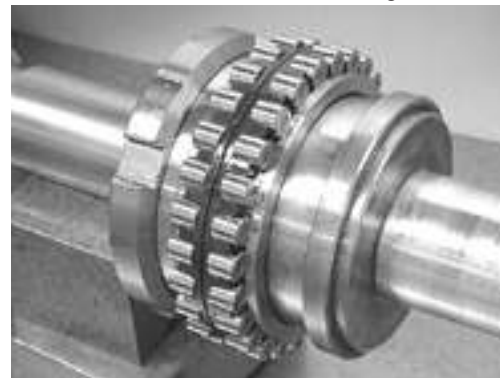
Abb. 1.13: Einstellen des GN-Hüllkreismessgerätes
