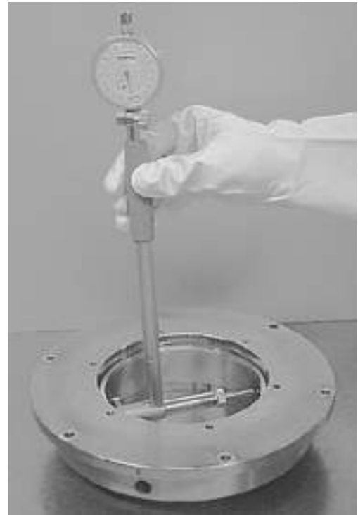
Abb. 1.11: Laufbahndurchmesser des Außenrings auf das GN-Hüllkreismessgerät übertragen
